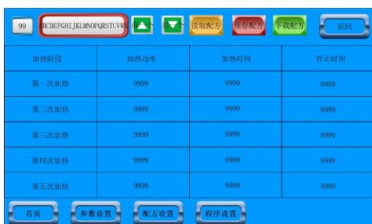
【配方序号】这里输入0~30，表示总共可以储存30个配方，当储存好配方后，如需调用以前储存的配方，只需输入序号即可调用。
