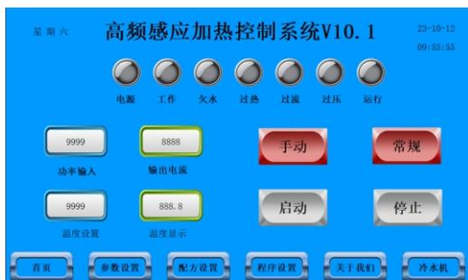
【电源】冷水机和高频焊电源，工作时此按键显示绿色。按下后进入冷水机等待启动，7秒后按下冷水机面板上的启动按键，整机进入正常工作状态。
